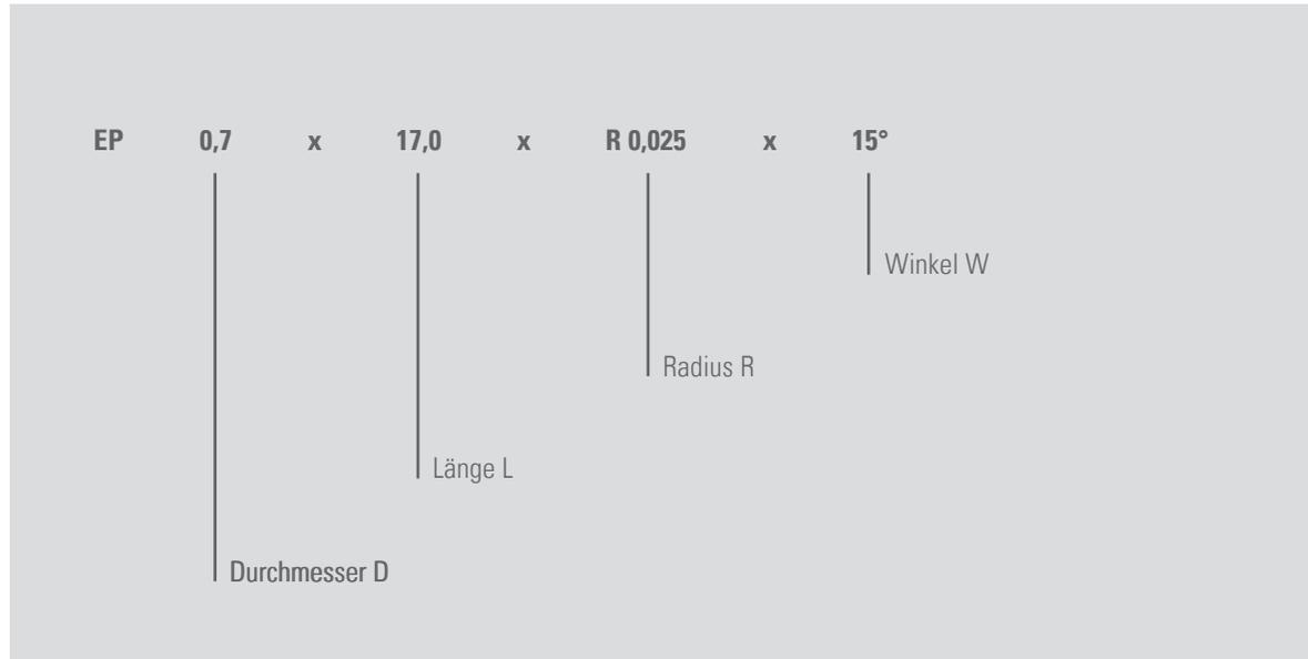
Außstoßnadeln werden im Bereich der Waferherstellung eingesetzt. Sie dienen dazu, die Bauteile von der Waferfolie zu heben, um dem Pick-up tool das Abheben zu ermöglichen. Anzahl und Form der Nadeln variieren je nach Produkt.
